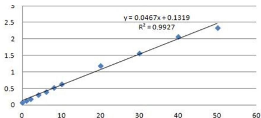
**注意:** 由于检测仪器和操作手法等条件的不同, 标准曲线会有差异, 该值仅供参考, 根据测定经验显示 Vc 标准在 0.5  $\mu\text{g}$  以下, 60  $\mu\text{g}$  以上, 标准曲线会有偏差。
